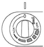
Если температура в парильне по какой-либо причине поднимается слишком высоко, предохранитель от перегрева термостата полностью отключит нагревательные элементы.
