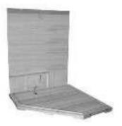
3. Присоедините две задние панели, предварительно совместив отверстия и закрутите саморезы.
